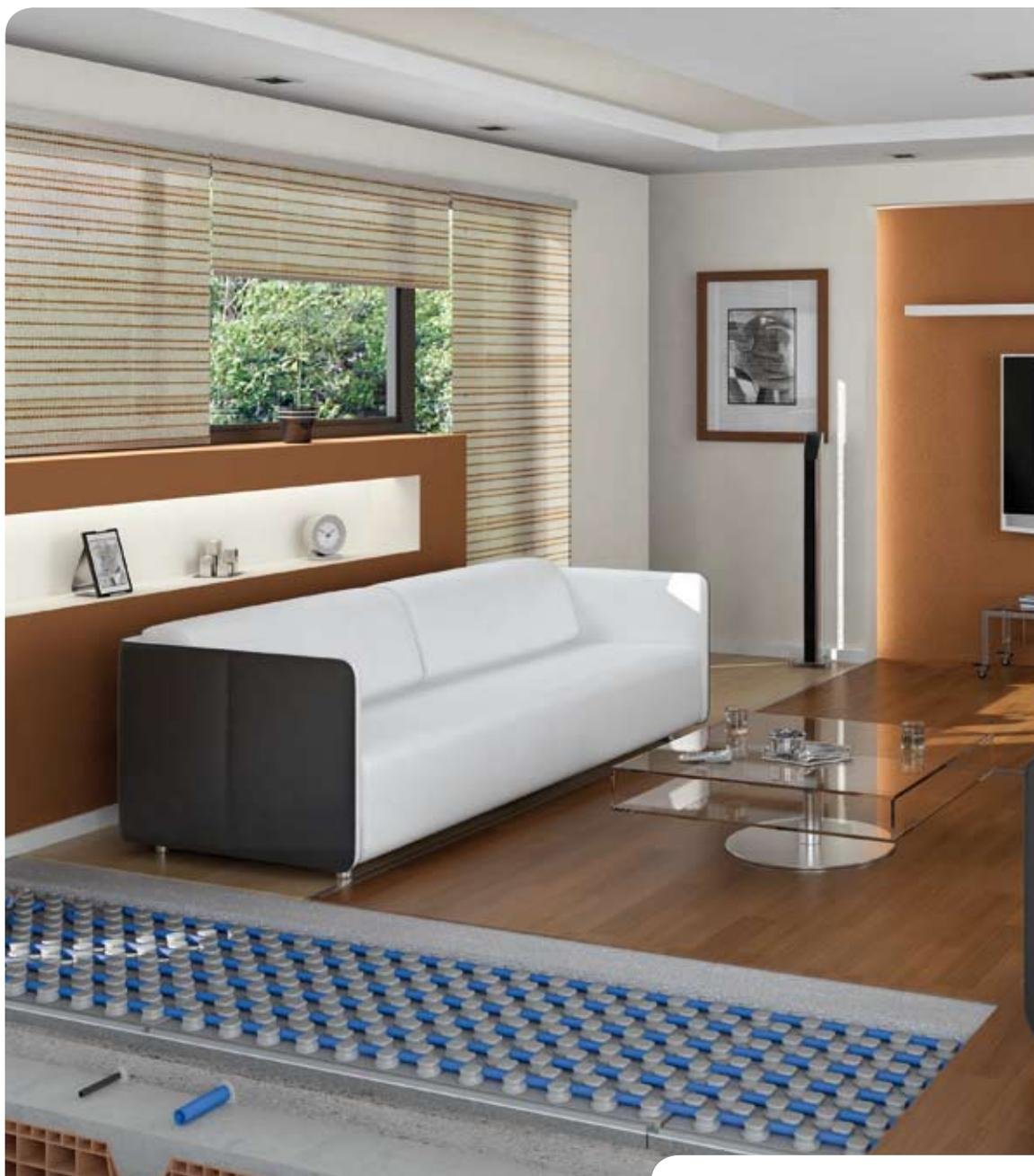
**Disteso® Radiante** è costituito da **Disteso®**, l'isolante termico anticalpestio a marchio CE in polistirene elasticizzato EPS T di vari spessori, da 22, 33 oppure 43 mm (Isolamento Acustico al calpestio certificato  $\Delta L = 37,5$  dB), accoppiato ad un polistirene (EPS 250) di spessore 15 mm con bugne in rilievo di altezza 26 mm che consentono l'alloggiamento di tubi di diametro 16 mm, 17 mm o 18 mm, a passi multipli di 50 mm.
